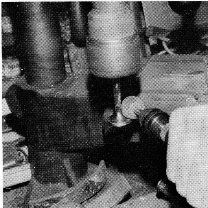
Bild 2. Das Ventil wird in eine Ständerbohrmaschine gespannt und mit dem Fächerschleifer bearbeitet.
